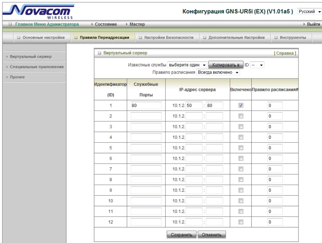
Виртуальный компьютер позволяет использовать оригинальные функции NAT, а также позволяет вам настроить взаимно-однозначное отображение нескольких глобальных IP адресов и локального адреса IP.
