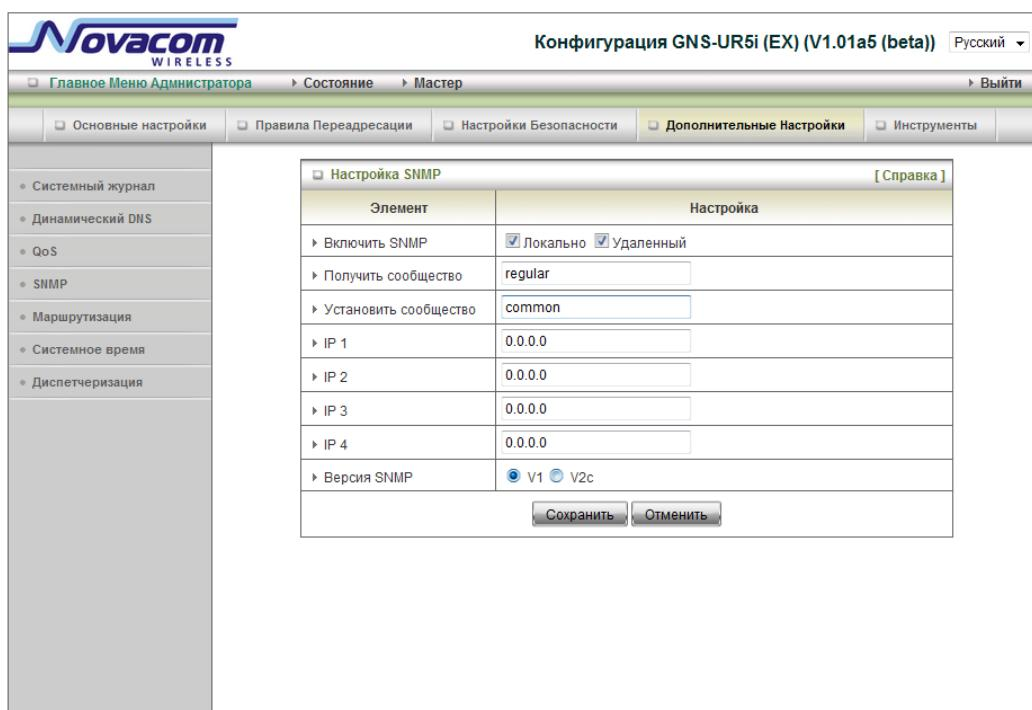
SNMP, Простой Протокол Управления Сетью, является протоколом, разработанным, чтобы дать пользователю способность управлять компьютерной сетью, выбирая и устанавливая предельные значения и отслеживая действия в сети.
