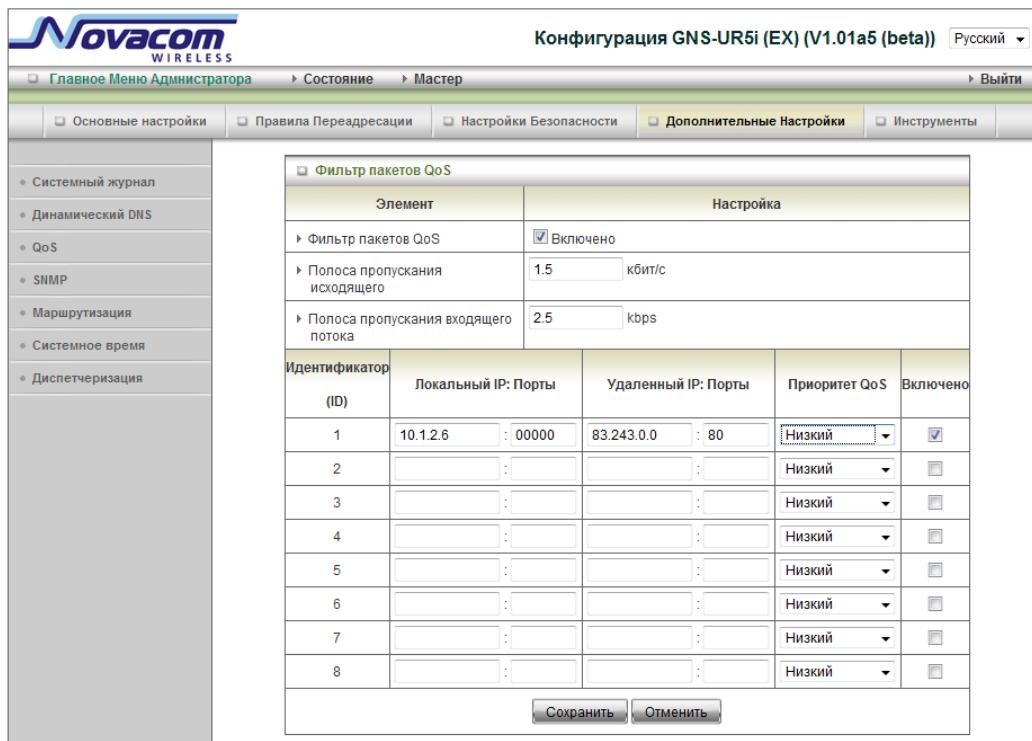
Обеспечивает различные приоритеты для различных пользователей или потоков данных, либо гарантирует определенный уровень производительности.
