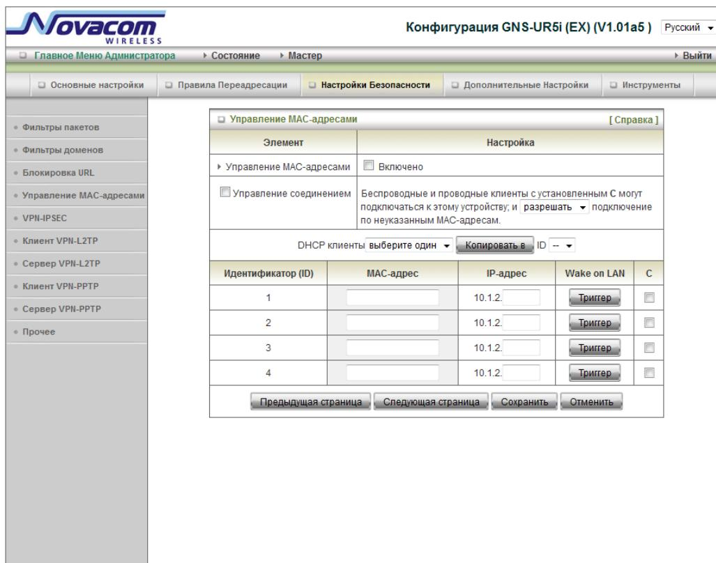
Контроль MAC-адресов позволяет назначить различные права доступа для разных пользователей и назначить конкретное значение IP-адреса для определенного адреса MAC.
