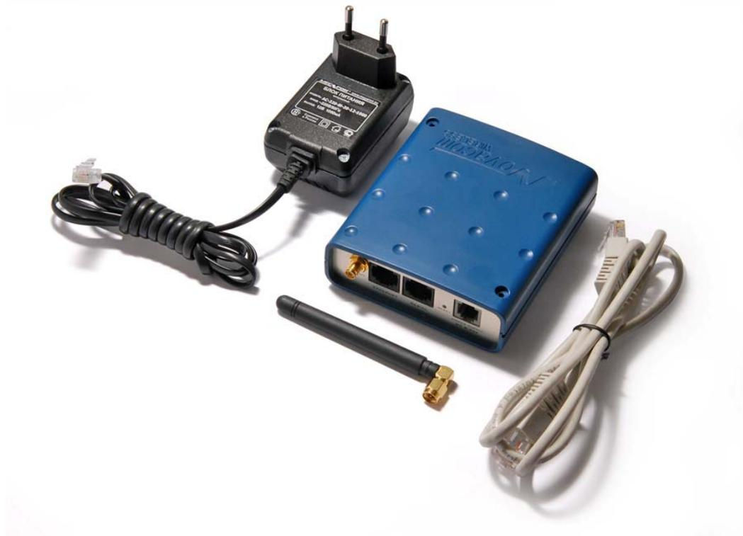
Роутер Novacom Wireless GNS-ER75i использует технологию EDGE для надёжного высокоскоростного доступа в интернет отдельного устройства или целой Ethernet-сети. Он может быть использован для подключения к сети Интернет компьютеров и сетей, торговых автоматов и банкоматов, промышленного оборудования и систем охраны и наблюдения, а так же для удалённого мониторинга и управления. GNS-ER75i обладает большим набором различных функций, которые легко настраиваются и удобны в использовании:
