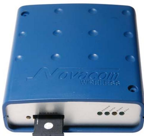
Рис. 7б. Установка SIM-карты в роутер
